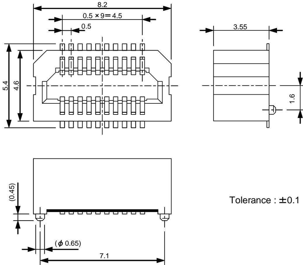
図 2.9.12 SICAP20S図面
